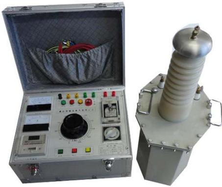
控制箱油浸式变压器一套
