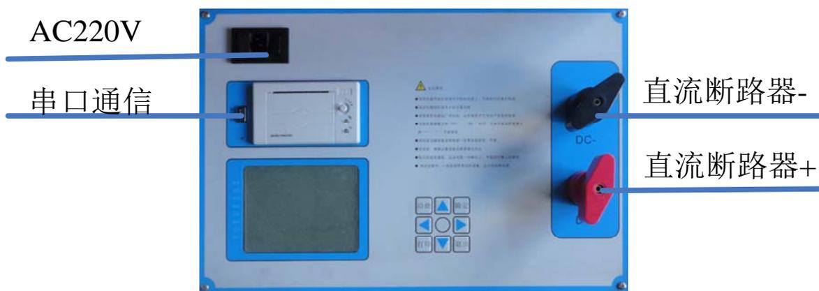
图 1 接线示意图（500A 型参考）
