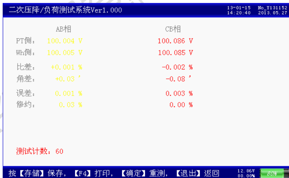
图七 三线压降测试 正常
