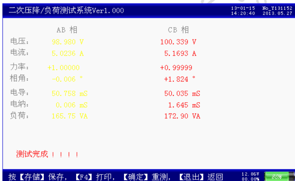
图十三 三线 PT 负荷测试 正常
