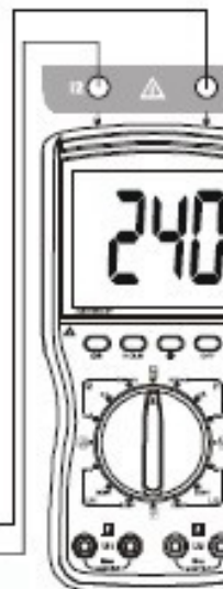
测试三相三线Ia-Ic的相位
