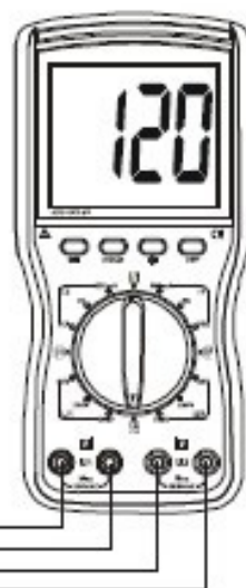
测试三相四线Ua-Ub的相位 判断三相四线制的相序
