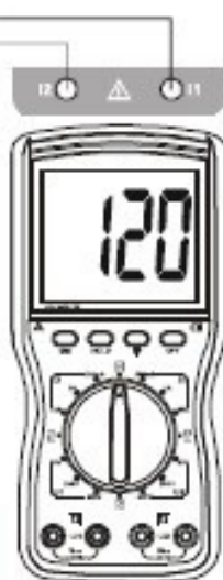
测试三相四线Ia-Ib的相位
