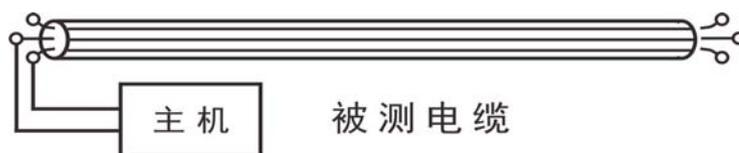
低压脉冲法接线图
