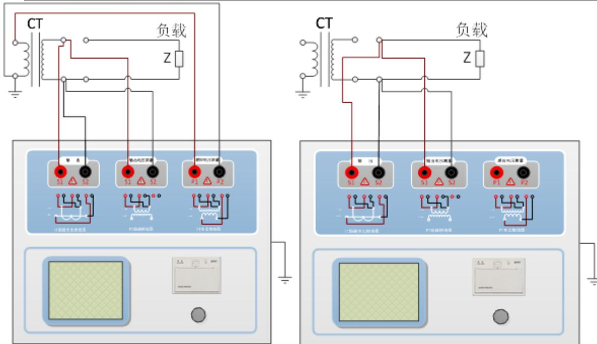
图2.1 CT直阻、励磁、变比试验接线方式
