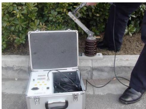
第三步 测量触指压力
