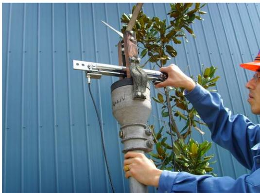
第三步 测量触指压力
