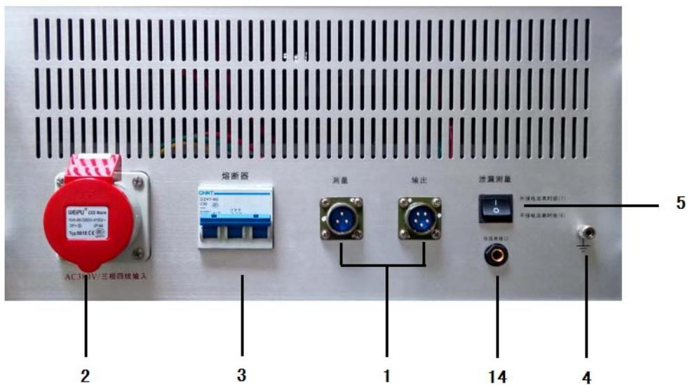
图 3 ZZG-S 大功率机箱后板示意图
