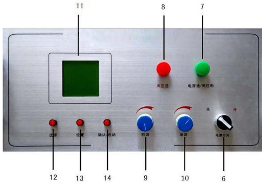
图 2 ZZG-S 大功率机箱面板示意图
