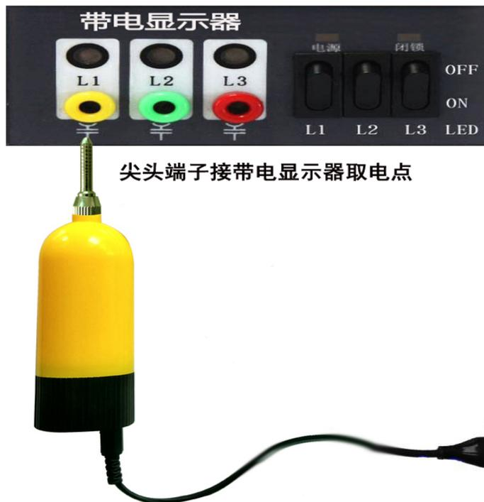
带电显示器核相示意图 (图3)
