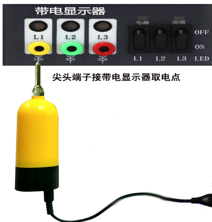
带电显示器核相示意图（图3）
