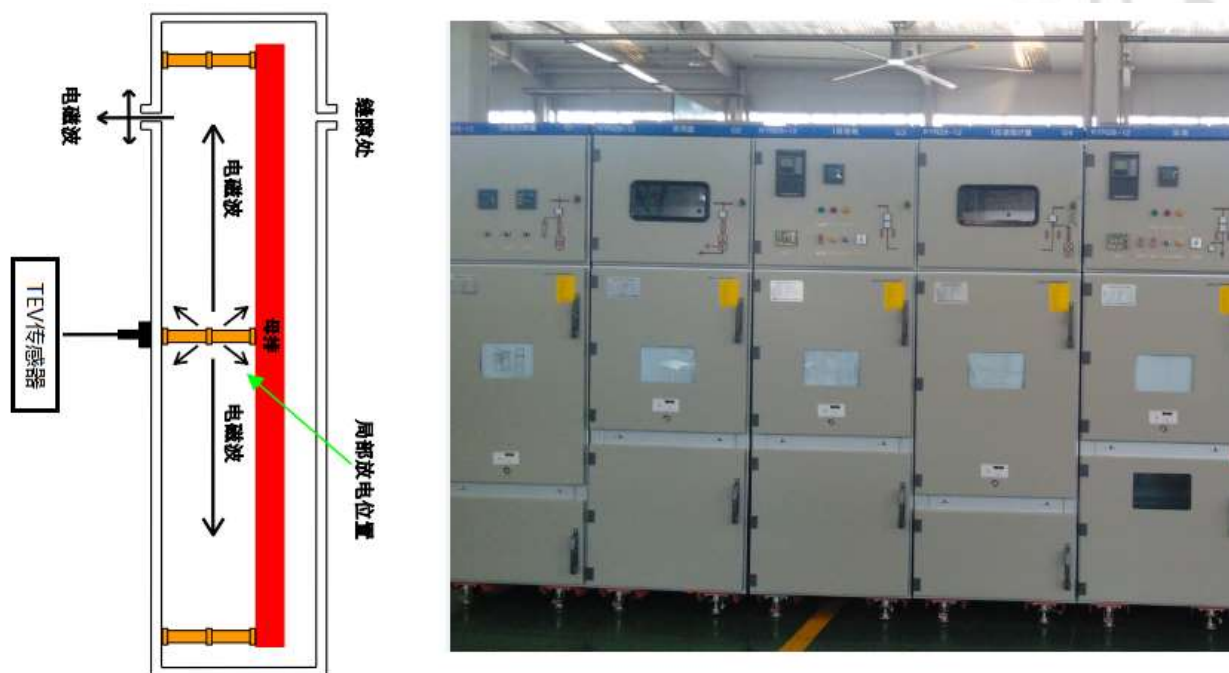
图 5-1 TEV 检测原理
