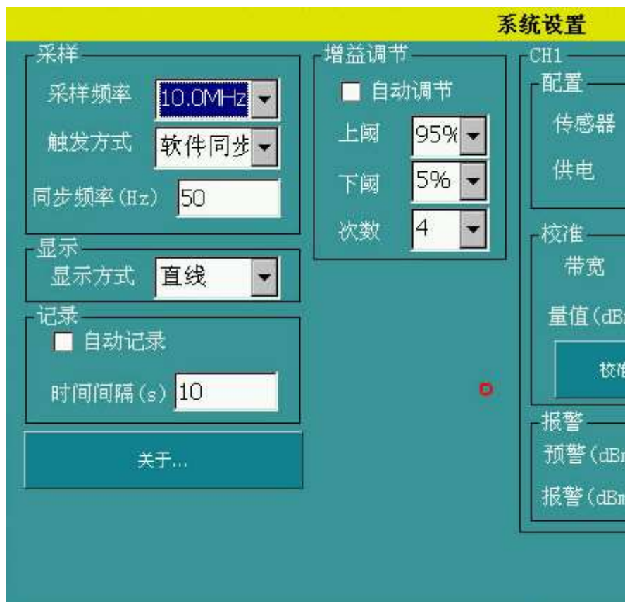
图 4-5 系统设置对采样、显示、记录以及增益调节的设置
