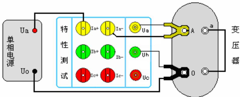
图 26、单相变压器短路损耗测量
