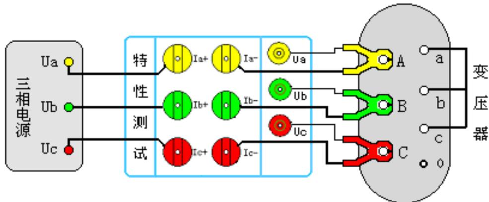
图 27、三相电源测量变压器短路损耗
