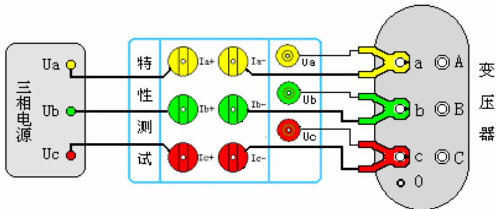
图 25、三相电源测量变压器空载损耗
