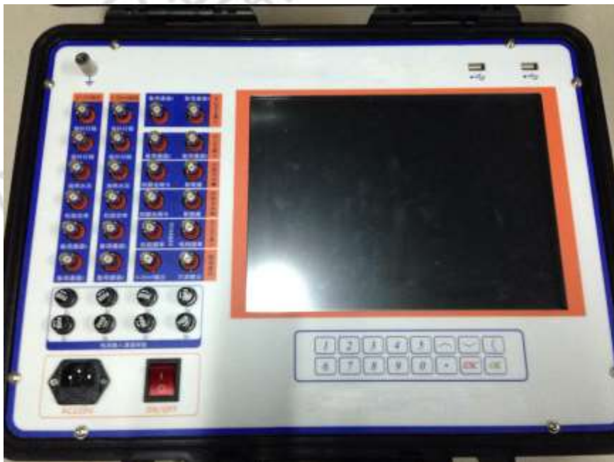
图 2.1 水轮机调速器仿真测试仪 硬件系统面板如图 2.1 所示，整个面板分为三个区域。
