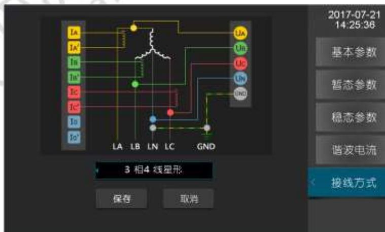
图 0-7 参数设置-三相四线星型接法
