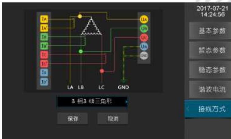
图 0-6 参数设置-三相三线三角形接法
