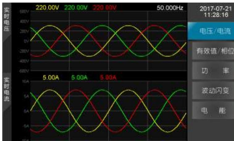
图 0-1 实时波形-电压/电流
