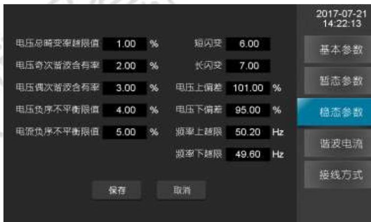
图 0-3 参数设置-稳态参数
