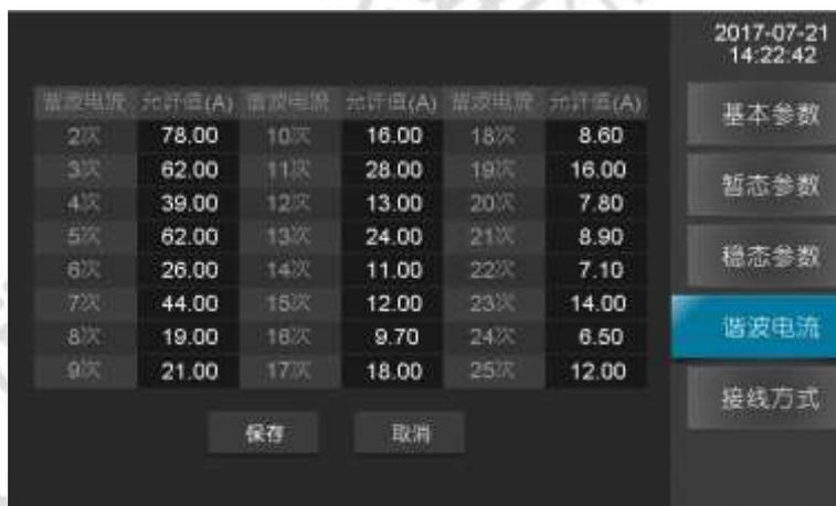
图 0-4 参数设置-谐波电流
