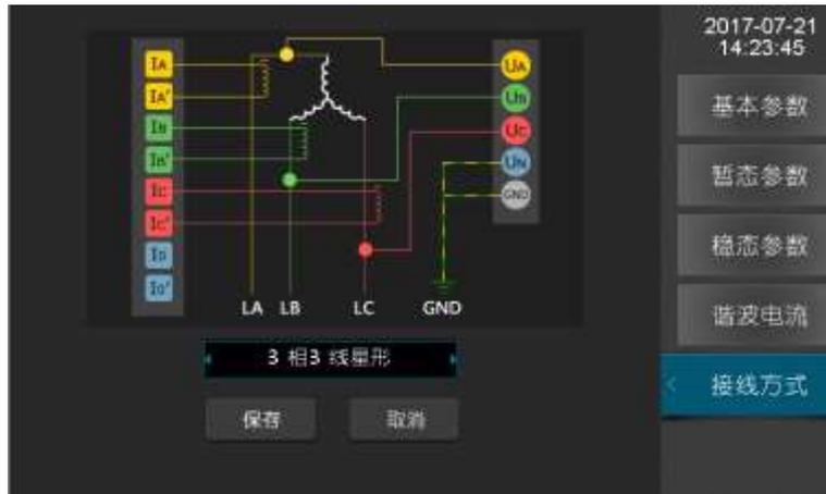
图 0-5 参数设置-三相三线星型接法
