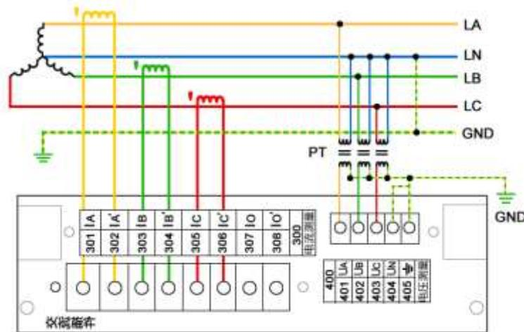
图错误!文档中没有指定样式的文字。-5 三相四线星形接法
