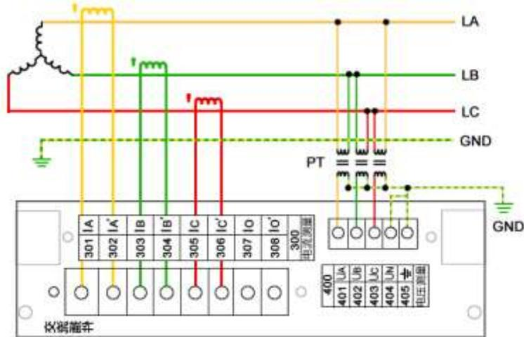
图错误!文档中没有指定样式的文字。-6 三相三线星形接法
