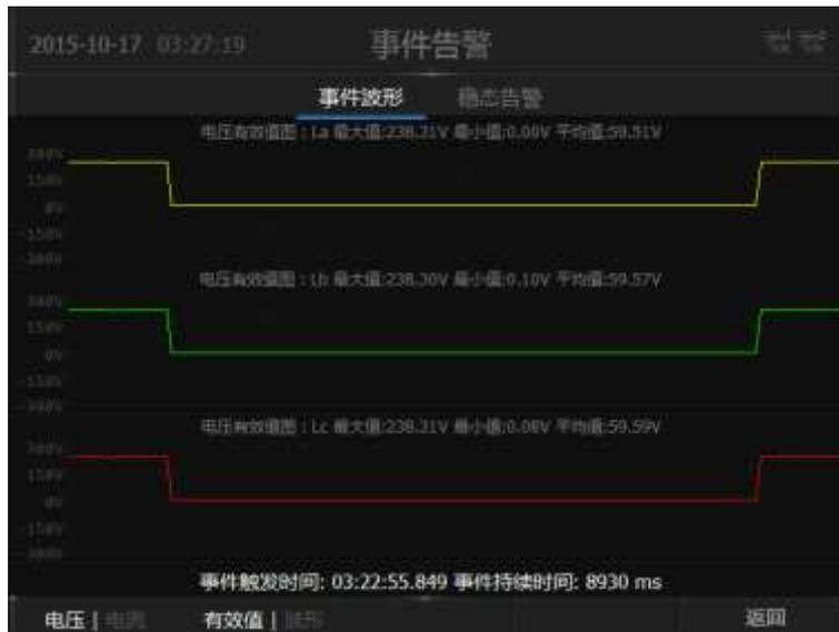
图错误!文档中没有指定样式的文字。-36 暂态事件回显
