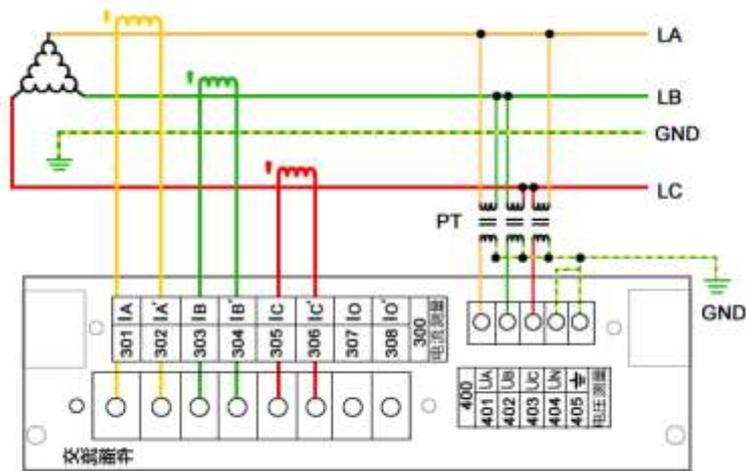
图错误!文档中没有指定样式的文字。-7 三相三线三角形接法
