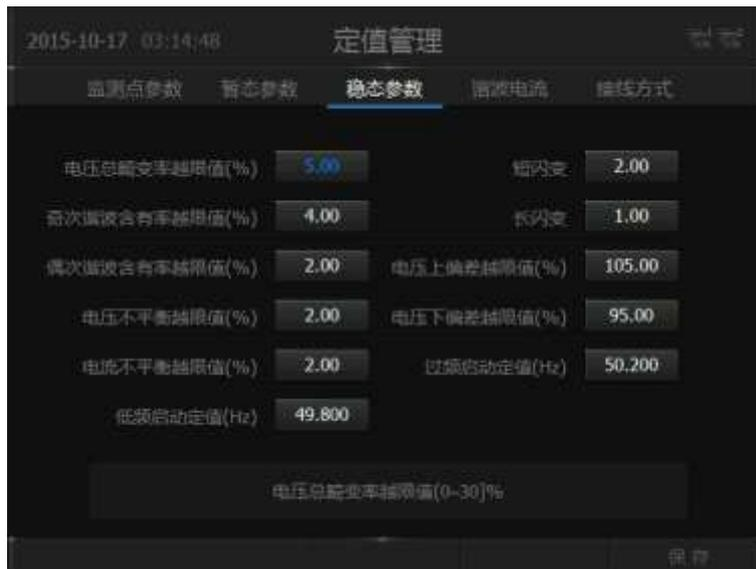
图错误!文档中没有指定样式的文字。-31 稳态参数页面效果图
