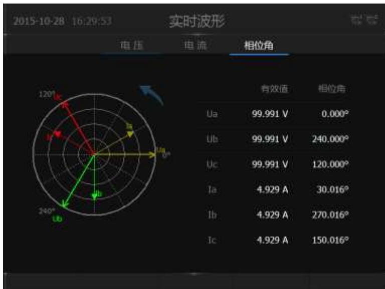
图错误!文档中没有指定样式的文字。-12 波形显示-电流界面
