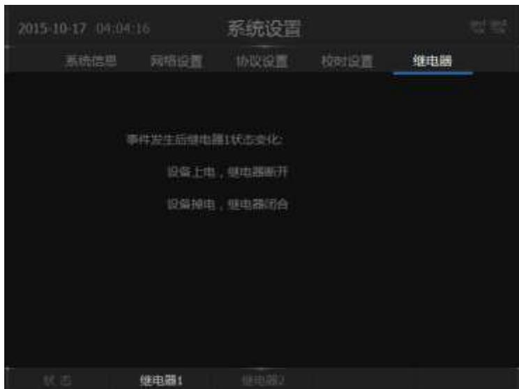
图 错误!文档中没有指定样式的文字。-44 继电器 1 状态页面
