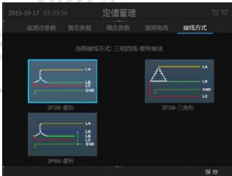
图错误!文档中没有指定样式的文字。-33 接线方式界面
