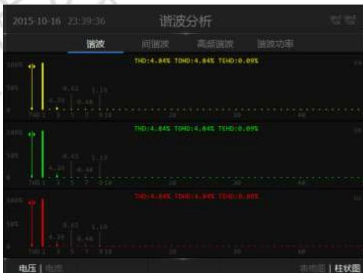
图错误!文档中没有指定样式的文字。-13 谐波分析-谐波电压柱状图
