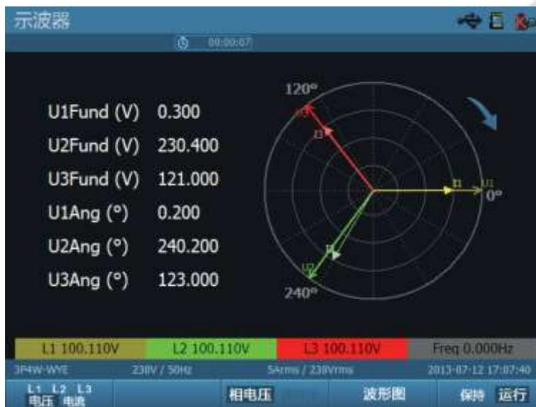
图 7-4 示波器矢量图界面
