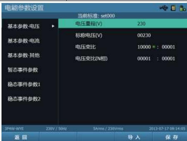
图 6-7 电压参数界面
