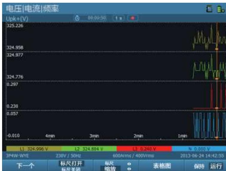
图 8-3 电压电流频率趋势图模式界面
