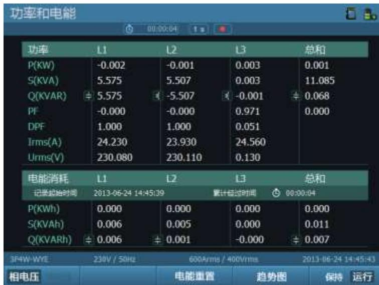
图 11-2 功率和电能表格图界面
