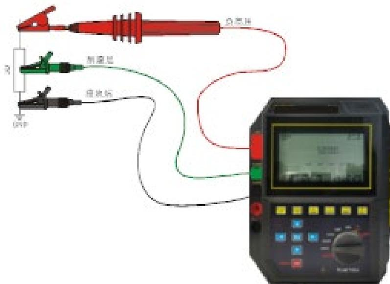
**注意：**在接线时严禁将LINE与GUARD长时间短路，以免发生过载现象！
