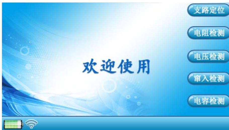
按压“支路定位”进入系统接地故障支路定位界面。按压“电阻检测”进行系统对地绝缘电阻检测并跳转到绝缘电阻检测界面。按压“电压检测”进行直流电网电压检测并跳转到电网电压检测界面。按压“窜入检测”进行交流 50hz 窜入检测并进入窜入检测界面。按压“电容检测”进行系统对地电容检测并进入系统电容检测界面。
