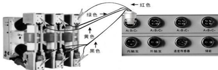
断口接线图（六断口）
