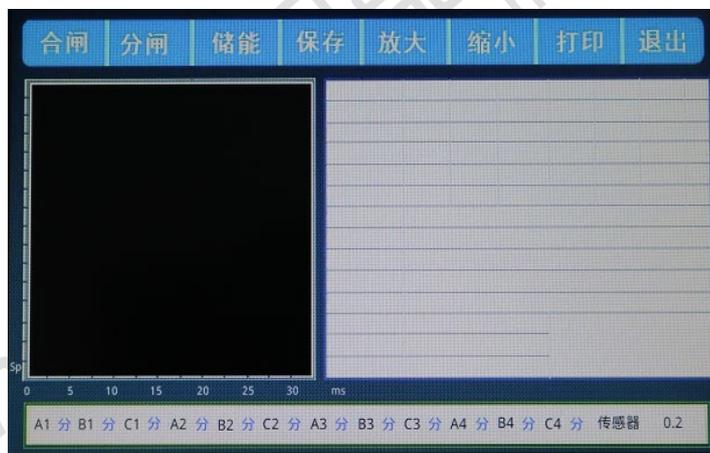
(1)、**合闸测试**：点击此菜单，合闸电压输出，测量合闸时间、弹跳时间及次数、三相不同期、速度等参数同屏显示，如下图：
