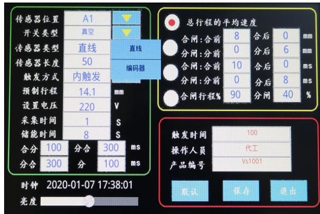
(4)、**传感器长度**：直线传感器的长度如果是 50mm 的，在此外就设置 50 即可，如果是 300 的直线传感器就设置 300 即可。根据使用的传感器长度进行设置，仪器自适应计算。点击数字，弹出设置键盘，输入正确数字，按 Enter 确认，如下图：
