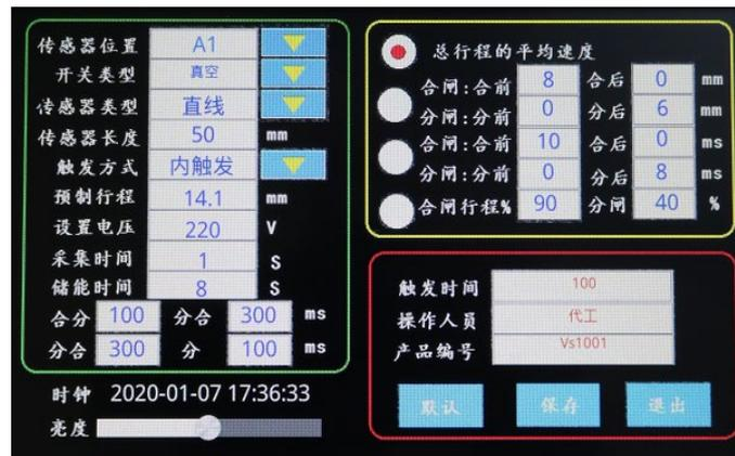
(1)、**传感器位置:** 传感器位置默认为 A1 断口，根据传感器安装的实际情况进行设置，如不测速度行程，不需要设置。
