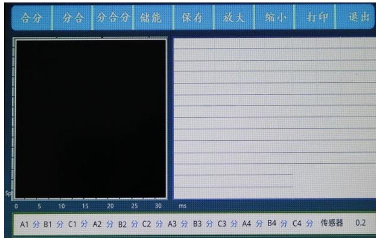
E、**低跳试验**：此菜单有自动低跳和手动低跳两种功能，选择**自动低跳**，必须接断口线，识别断口状态才有进行测试。**手动合**和**手动分**，不需要接断口线，直接给线圈加电压。起始电压和累加电压都可以设置，如下图：
