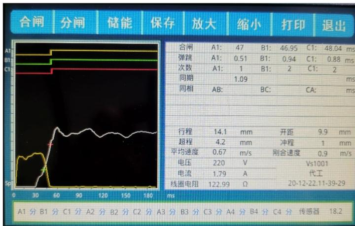
(2)、**分闸测试**: 点击此菜单, 分闸电压输出, 测量分闸时间、三相不同期、速度等参数。
