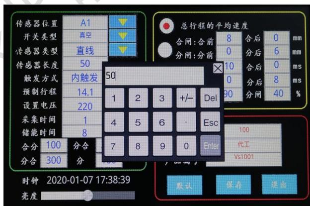
(5)、**触发方式**：触发方式有内触发、外触发、自触发（也叫手动触发）三种方式。
