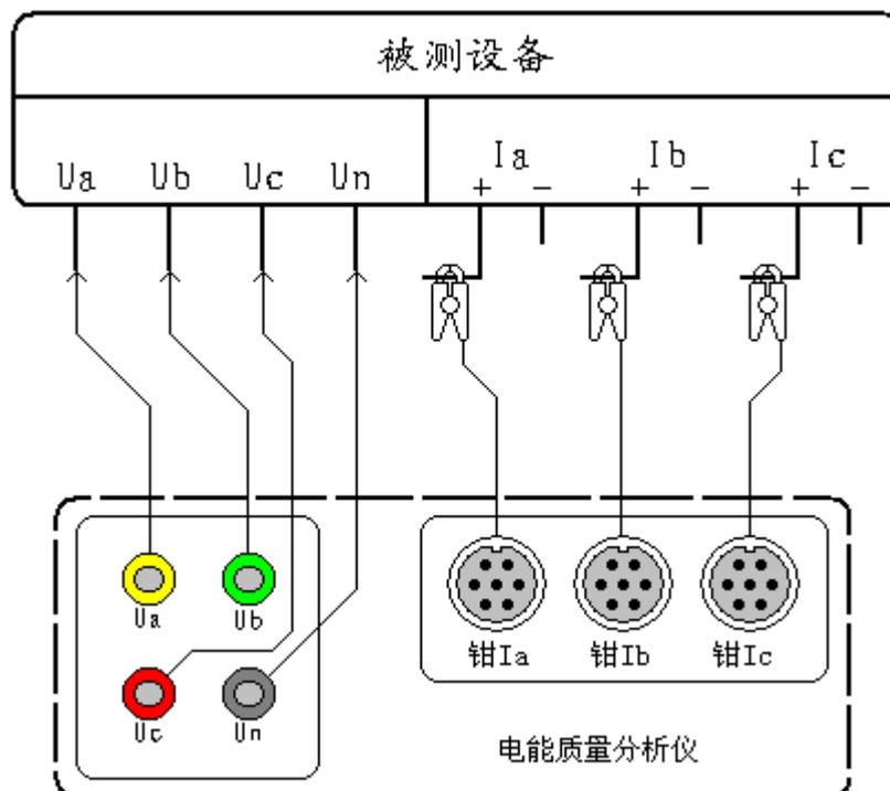
图十四、三相四线制设备测试接线图
