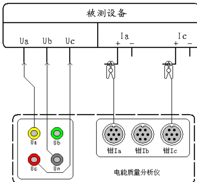
图十五、三相三线制设备测试接线图
