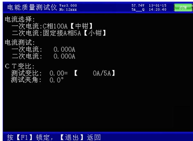
在此功能下，进行低压 CT 的变比和角差测试。图中可见：屏幕中提示出一次电流和二次电流测试应使用的钳表分别为：一次用 C 相中号钳表，二次用 A 相的 5A 小号钳表。钳表不能用错，注意一次电流必须用中号钳表或大号钳表进行测量，否则可能会超过仪器的电流量程。在参数设置中应按照一次电流所使用的钳表量程来设置。
