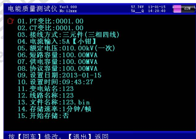
**PT 变比：**指被测装置所用的电压互感器的变比数值。输入方法为：按确认键使数字变成红色，此时再按相应的数字键输入数据，完成后再按确认键结束。
