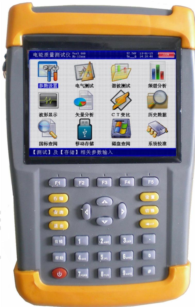
仪器正面上方是液晶显示器，下方是按键区，顶端为接线部分，右侧为其它端口（通讯、充电、USB）区域。
