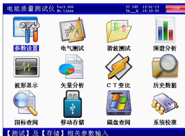
菜单名称反显，屏幕下端蓝条显示相关功能提示，按确定键进入相应功能测试和设置；屏幕右上角显示出内置充电电池的剩余电量百分比，用户可根据此数值来判断是否需要为仪器充电；电池左侧显示出当前实时的日期和时间；时间左侧显示当前测试仪的电压和电流的测量档位，电压档位的改变为自适应，电流档位的改变需进入“参数设置”选项进行手动设置；屏幕左上角显示仪器名称、仪器编号及软件版本。
