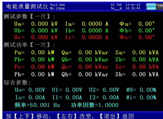
$U_0$ 、电流  $I_0$ ；正序电压  $U_1$ 、电流  $I_1$ ；负序电压  $U_2$ 、电流  $I_2$ ；电压和电流的不平衡度  $\#U$ 、 $\#i$ ；实测频率、总功率因数。按 F1 键能将当前屏幕锁定，便于读数，按 F2 继续刷新，按 F3 查看一次侧数据，按 F4 切换到二次侧界面。按退出键返回主菜单。
