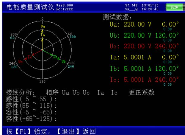
此屏可以直观的判断三相计量装置的接线是否正确，各相负荷的容、感性关系，上图所示为标准阻性负载时接线全部正确情况下的三相四线向量图。按 **F1** 键能将屏幕锁定，便于读数，按 **F2** 继续刷新。**退出**返回主菜单。
