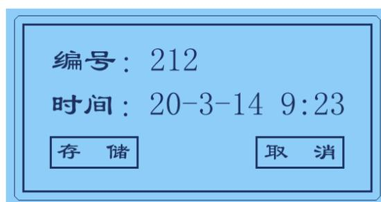
设备测量数据稳定后，可以将数据保存下来，按屏幕上“系统选项”按钮，调出主菜单界面，选择“打印数据”，可以将当前测试的数据打印出来，选择“保存数据”，可以进入数据保存界面。确认无误后可以按右下角的“保存”，将当前数据保存到仪器内部。仪器最多可以保存 1000 条数据。
