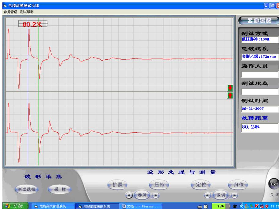
测故障时工作状态菜单选择“测故障”，在“工作方式”菜单选择“低压脉冲”，并选择适当电缆长度范围，按“确定”键，在按“采样”键后，屏幕下方测试结果区即显示故障波形。
