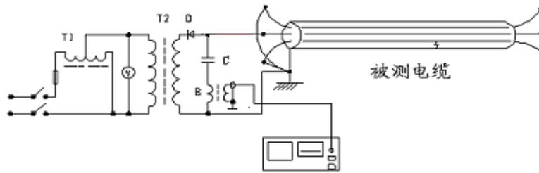
直闪法电流取样接线图
