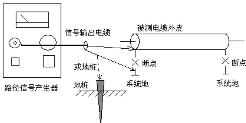
注：鉴于本仪器特点，一定要将被测电缆始端头的接地线与系统地断开。信号发生器的输出电缆中的红夹子接在被测电缆的始端头地线上或接在被测电缆的芯线上。输出电缆的黑夹子接在系统地上或接在接地电阻良好的地桩上，以保证被测电缆有较强的信号电磁场辐射。
