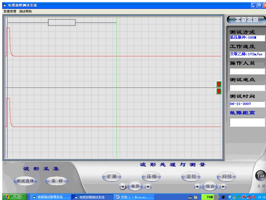
“工作方法”菜单：包括三个子菜单：“低压脉冲”，“冲闪电流法”，“直闪电流法”。
