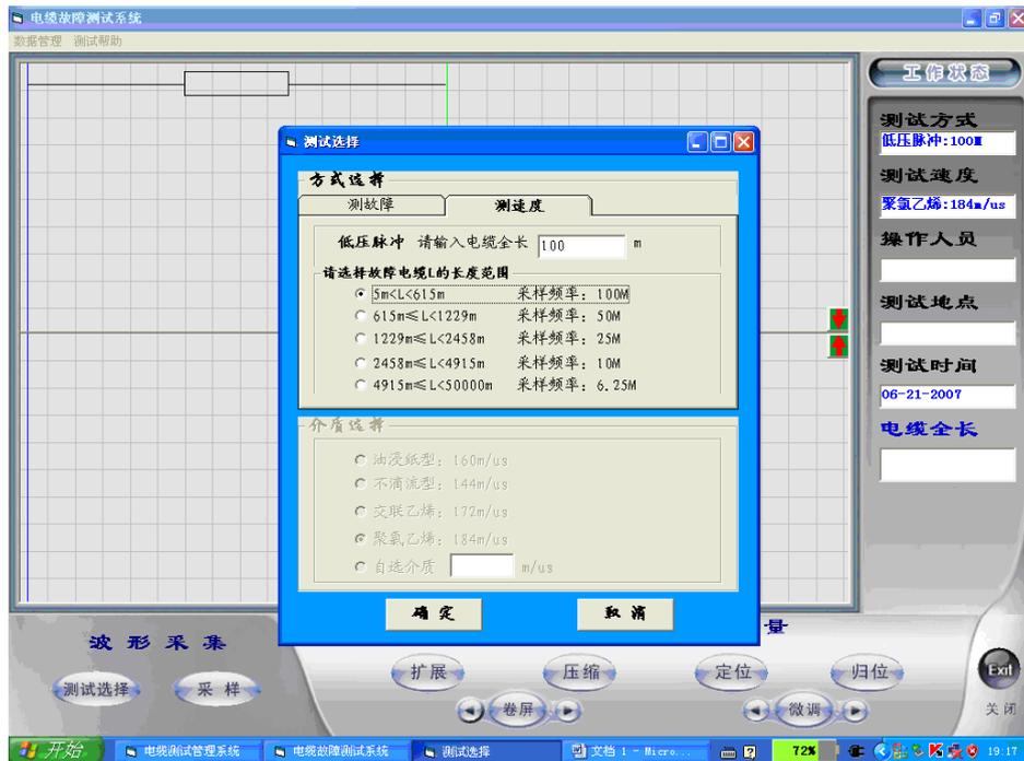
在“工作方式”菜单选择“测速度”、“低压脉冲”，根据电缆的大概长度，选择适应的范围，键入电缆全长，输入时请点击测试软件界面左下角小任务栏的#小键盘（本机出厂时已给你设定好了），输入你所选择的电缆长度。
