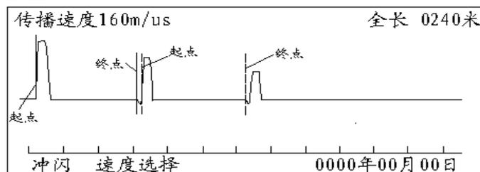
冲闪法电流取样测试波形
