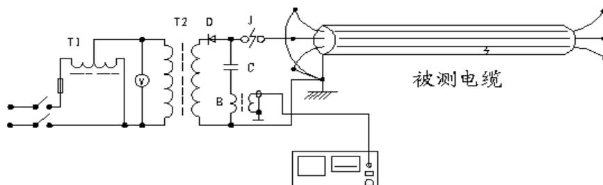
冲闪法电流取样接线图
