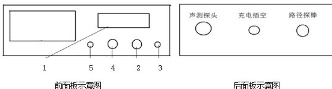
1. 距离显示屏      2. 定点/路径      3. 耳机插座      4. 音量调节      5. 欠压指示
