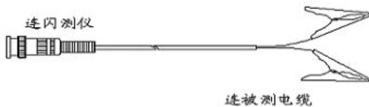
图7. 连接电缆示意图
