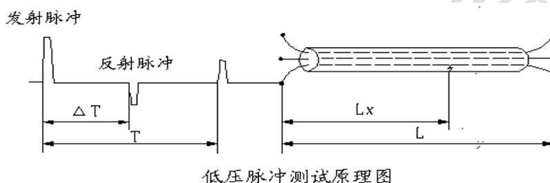
测量电缆故障时，电缆可视为一条均匀分布的传输线，根据传输线理论，在电缆一端加上脉冲电压，该脉冲按一定的速度（决定于电缆介质的介电常数和导磁系数）沿线向远端传输，当脉冲遇到故障点（或阻抗不均匀点）就会产生反射，且闪测仪记录下发送脉冲和反射脉冲之间的传输时间 $\Delta T$ ，则可按已知的传输速度 $V$ 来计算出故障点的距离 $Lx$ ， $Lx = V \cdot \Delta T / 2$ ，如图 8 所示：测全长则可利用终端反射脉冲： $L = V \cdot T / 2$
