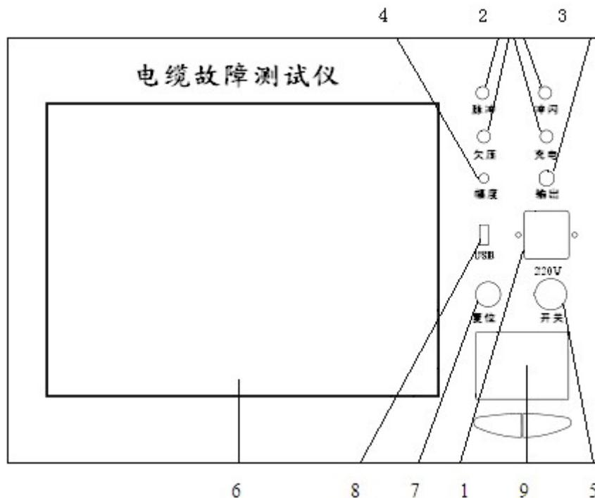
(1)电源输入插座：本仪器使用 50Hz、220V 交流电源供电，使用插入 220V 电源后，即开始充电，同时充电指示红灯亮。禁止在开机状态下直接充电。充电时间 6 小时以上。电池充满电后，同时充电指示红灯变绿，仪器自动保护。
