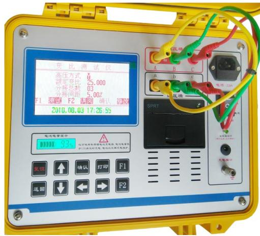
开机后，高压方式显示：D，按 **F1** 进行测试，测试结果显示如下图：
