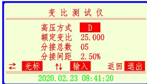
按下**向左**或**向右**键，光标可以在各个参数之间循环移动，可将光标移动到需要改变的参数上；
