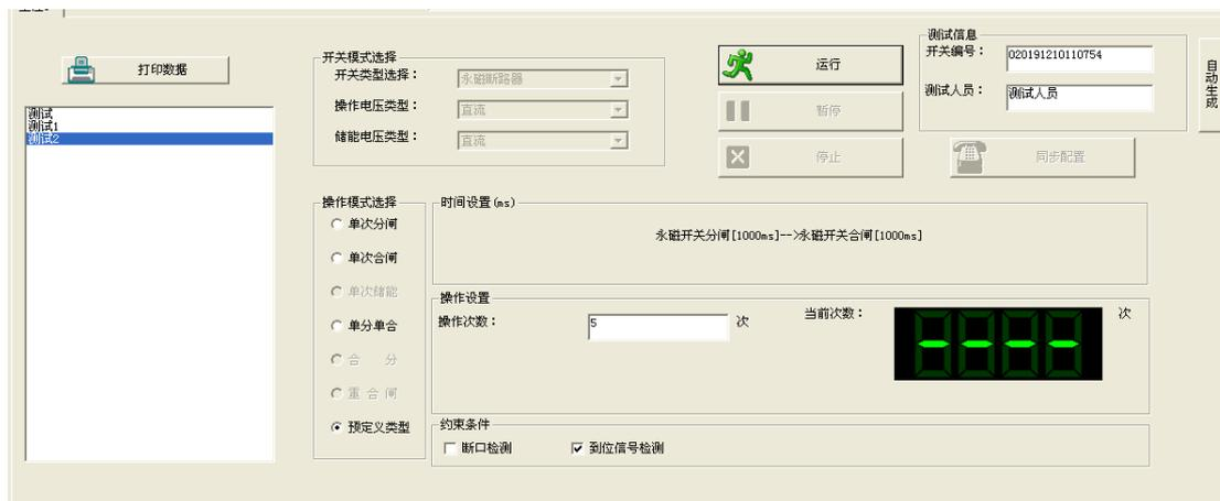
选择对应操作类型后，点击开始按钮，就可以进行磨合操作。需要暂停时按暂停，暂停时磨合次数不清零，再需要继续磨合时点运行会从上次磨合的次数开始计数，需要停止时按停止，停止时磨合次数自动清零，下次磨合计数是从零开始。
